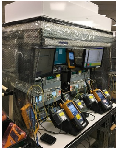
Abbildung 2 – Glasfaser-Kalibrierungsstation. Beachten Sie den Kunststoff um die Station auf dem Filtersystem auf der Oberseite um Staub zu minimieren. Manche der im Handel erhältlichen Produkte werden von Fluke Networks modifiziert, um unseren Präzisionsansprüchen zu genügen.
