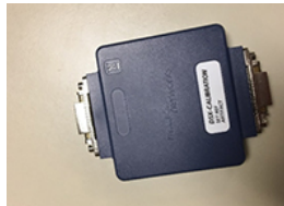
Abbildung 3 – Eins der siebzehn Kupferkalibrierungsartefakte, das in unseren Service-Centers verwendet wird. Geschützt in einem Kunststoffgehäuse.
