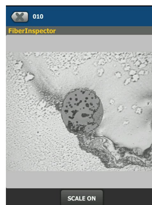
Spezielle Lösungsmittel (links) sind sehr viel effektiver bei der Stirnseitenreinigung als IPA, der einen Rückstand (rechts) lassen kann.
