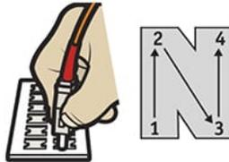
Abbildung 8: „Nass zu Trocken“: Reinigungsmethode mithilfe einer Fluke Networks Optic-Reinigungskarte. Der Tropfen Lösungsmittel wird auf „1“ platziert und die Endfläche wird auf dem Reinigungsmaterial von „1“ zu „4“ bewegt.
